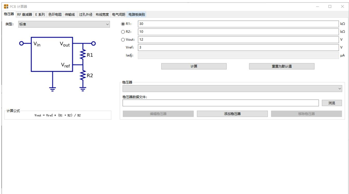
对于 *标准型*，输出电压  $V_{out}$  作为参考电压  $V_{ref}$  和电阻  $R1$  和  $R2$  的函数，由以下公式给出：
